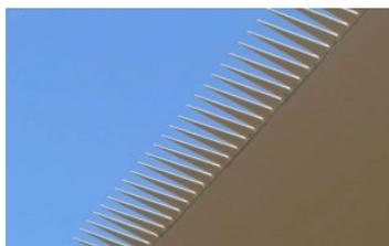
Pour le projet de la Montagne d'Estables, les éoliennes utilisées sont à la pointe de la technologie. Ainsi, un **système appelé TES (Trailing Edge Serrations), encore appelé « peignes », composé de « dentelures », sera mis en place sur les pales**, pour réduire les bruits d'ordres aérodynamiques.
